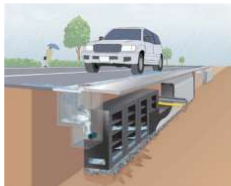
雨水貯留・浸透施設のイメージ
