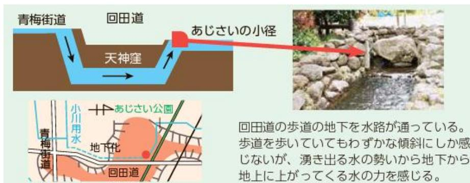
回田道の歩道の地下を水路が通っている。歩道を歩いてもわずかな傾斜にしか感じないが、湧き出る水の勢いから地下から地上に上がってくる水の力を感じる。
