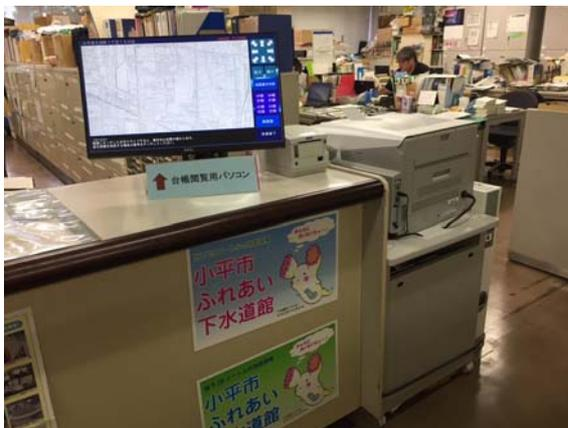
写真 3-7 下水道台帳システム（タッチパネル方式）
