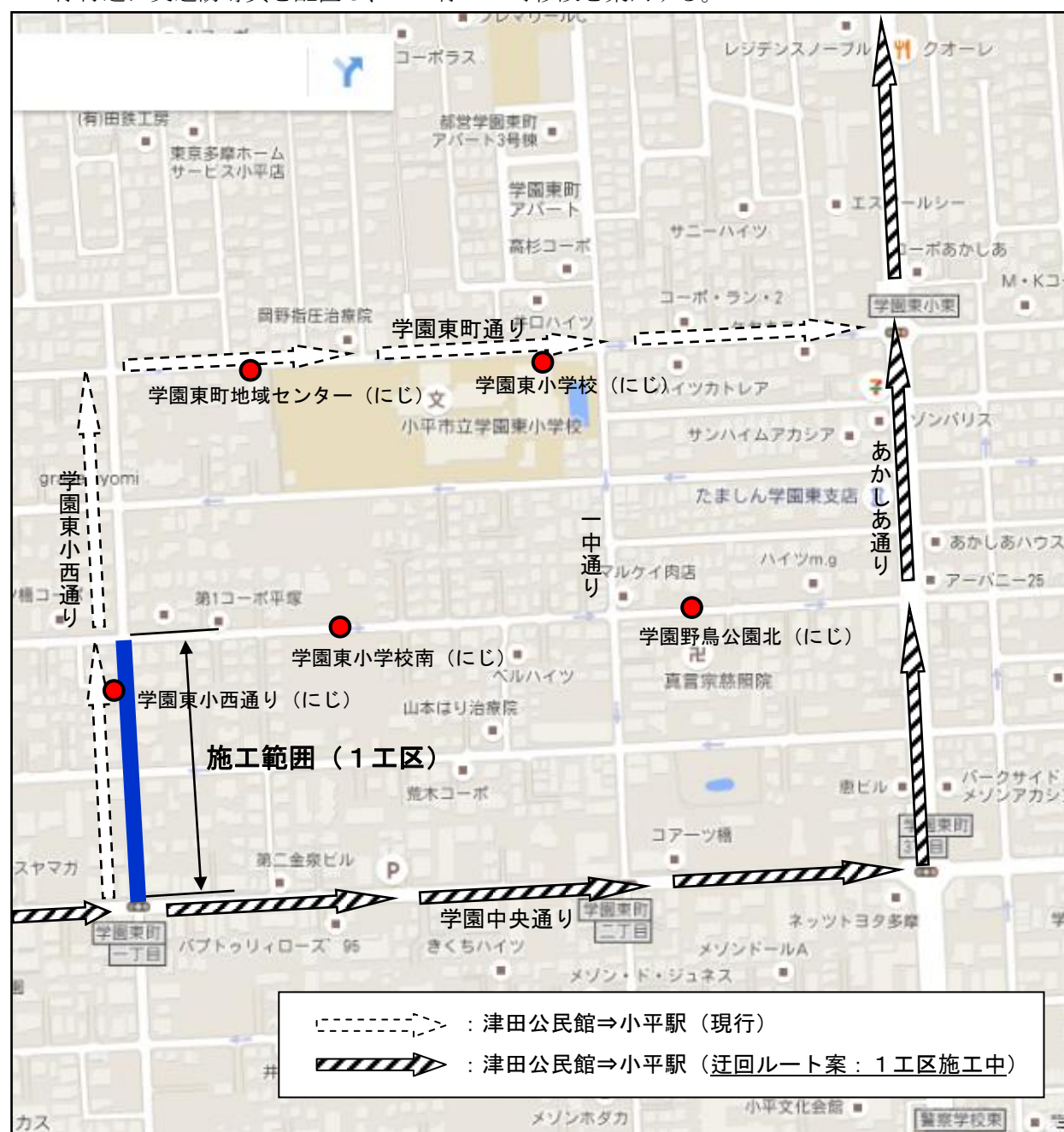
図-1 1工区（南側）施工中の迂回ルート案（土日を除く7日間を予定）
