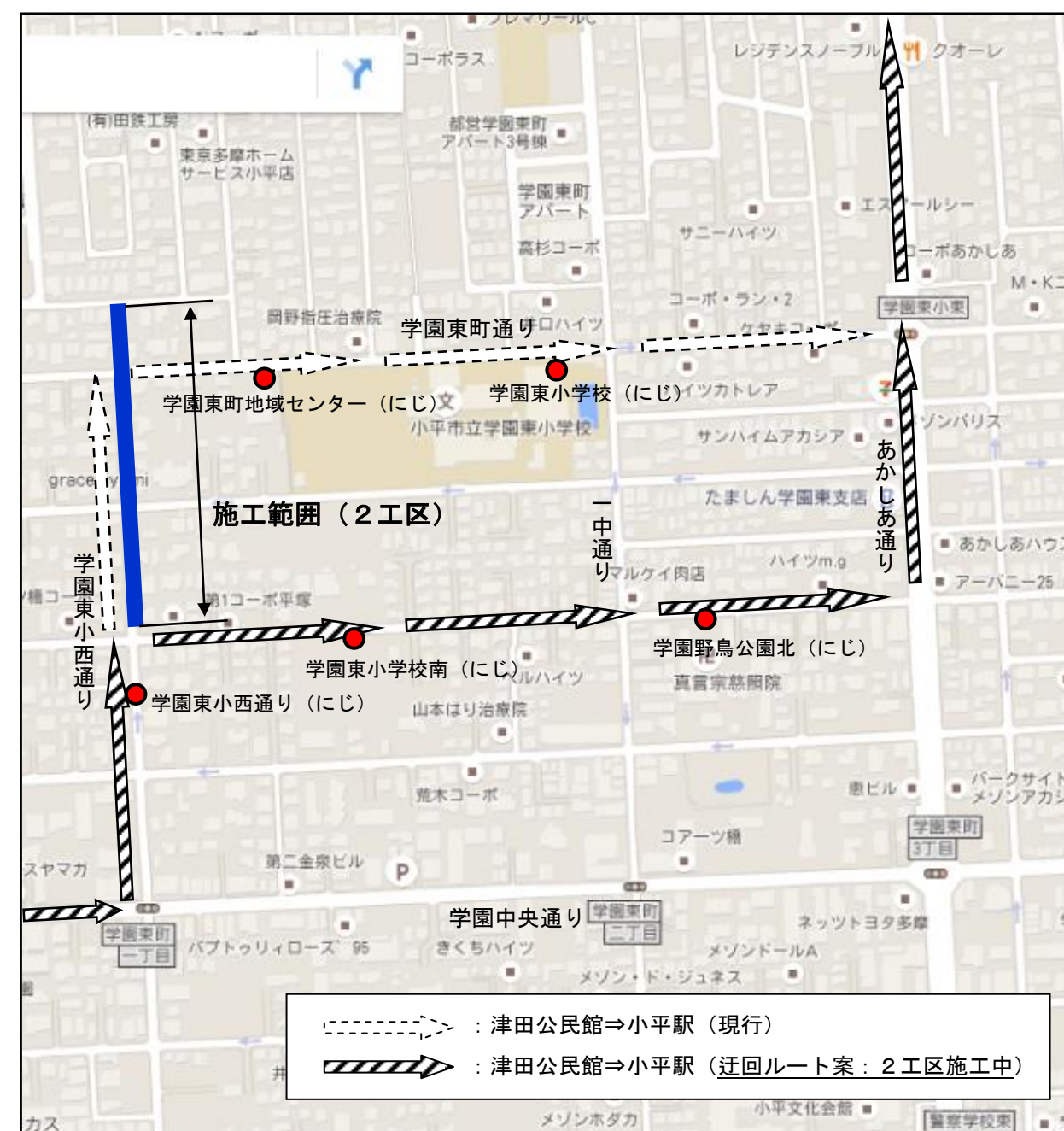
図-2 2工区（北側）施工中の迂回ルート案（土日を除く7日間を予定）
