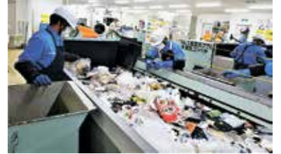
汚れているものや分別されていないものを手作業で取り除きます。
