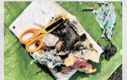
火災の原因となったタブレット端末(リチウムイオン電池内蔵)
